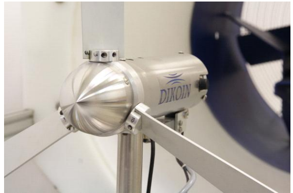
La turbina está completamente desarrollada y fabricada por DIKOID, y dispone de sistemas electrónicos de medida de velocidad de giro así como de par.
