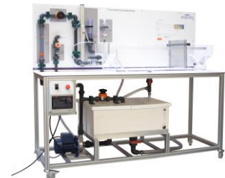
TA 02.2 - SEDIMENTATION TANK (pag. C - 4)
