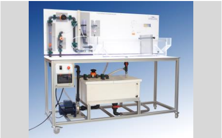
TA 02.2 - SEDIMENTATION TANK (pag. I - 2)
