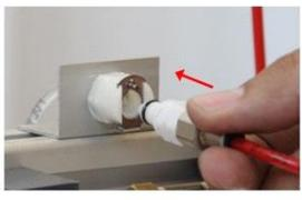
Para desconectarlos simplemente presionar la pieza metálica que hay en la parte superior del enchufe.
