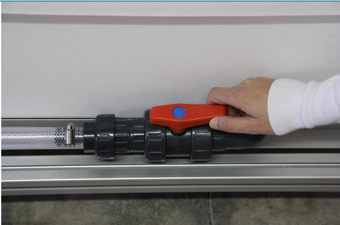
El depósito inferior dispone de un acople para el fácil llenado y vaciado del equipo.
