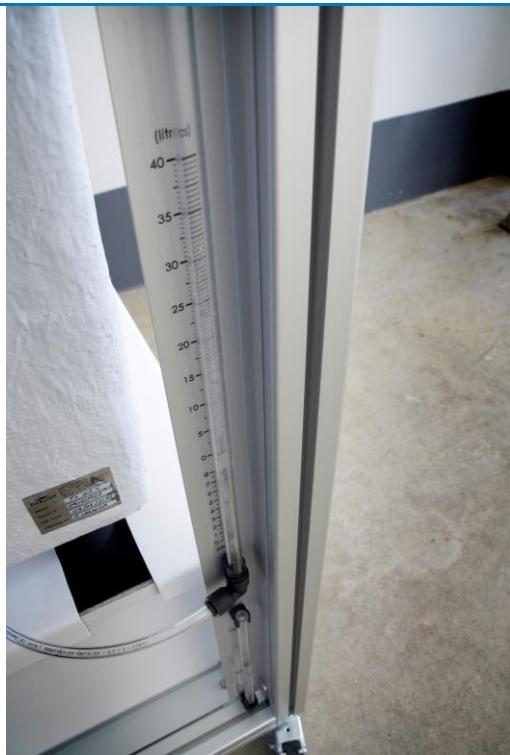
Los depósitos superiores disponen de reglas calibradas para facilitar el trabajo del alumno en las medidas de caudal.
