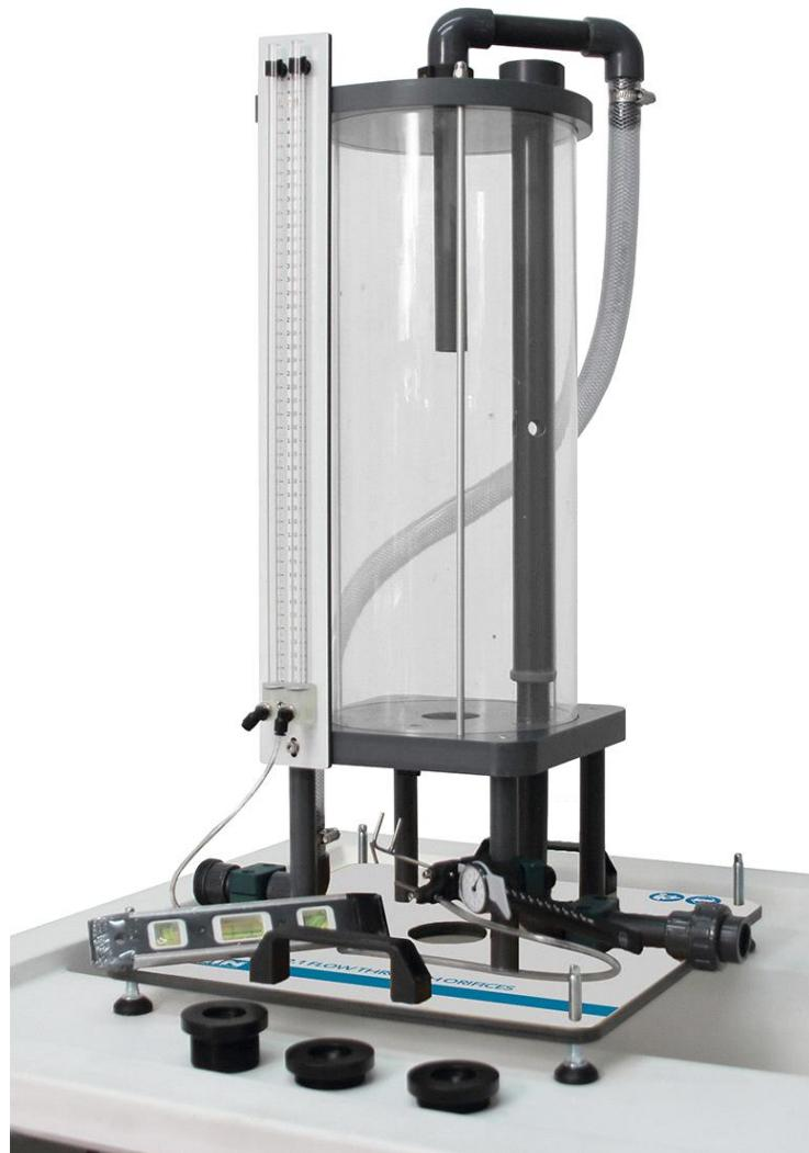
El equipo FL12.1 ha sido diseñado para el estudio de todo lo que concierne al fenómeno de contracción que se produce cuando un chorro de fluido atraviesa un orificio. Ha sido diseñado con especial hincapié en su utilización didáctica y es por ello que el equipo cuenta con tres boquillas cuya geometría difieren entre ellas, pudiendo realizarse ensayos en distintas condiciones, facilitando al alumno la compresión del fenómeno que se produce.
