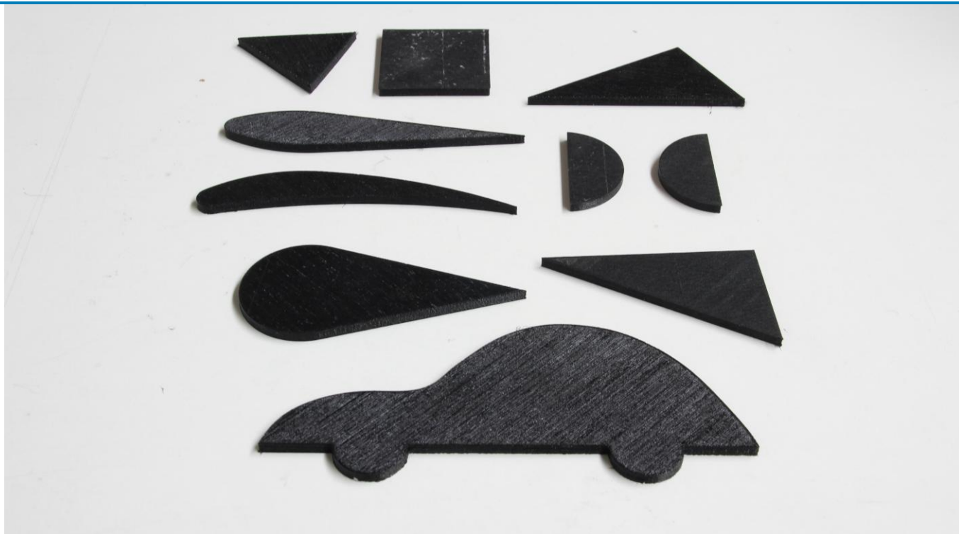
El equipo incluye diferentes modelos: perfil coche, perfil aerodinámico, círculo, rectángulo, cuadrado, etc.
