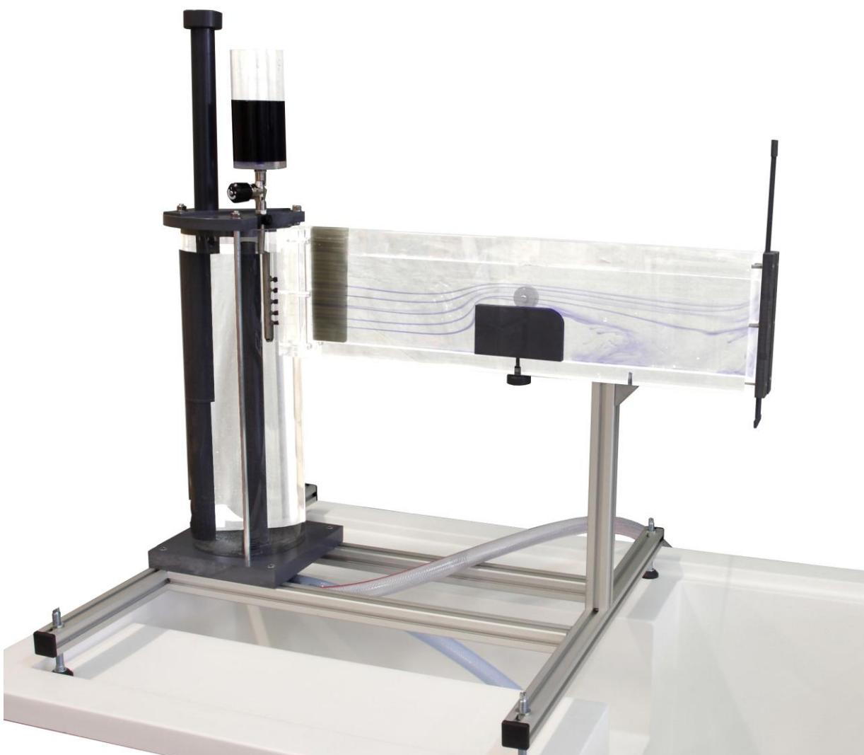
El canal miniatura de visualización de flujo permite estudiar el comportamiento de los fluidos en canales abiertos y las líneas de flujo que se forman alrededor de diferentes objetos sumergidos.
