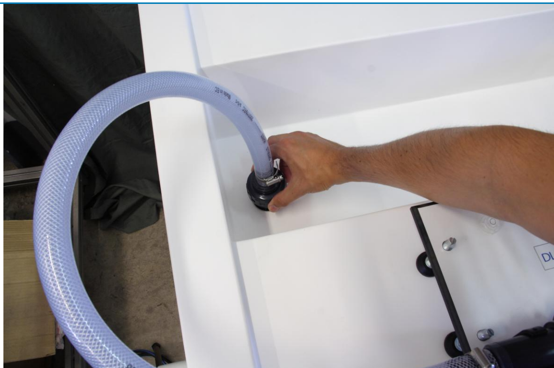
Facil conexionado al banco hidraulico.
