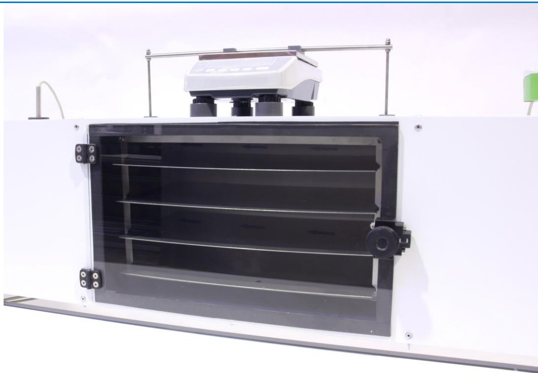
La zona de ensayo dispone de 4 bandejas en las que colocar el material a secar.
