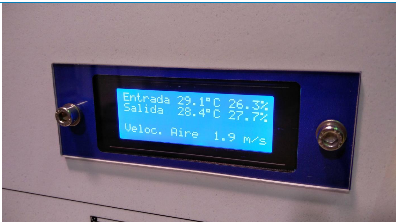
Los datos de los sensores de temperatura, humedad y velocidad de aire, son mostrados en un display electrónico.
