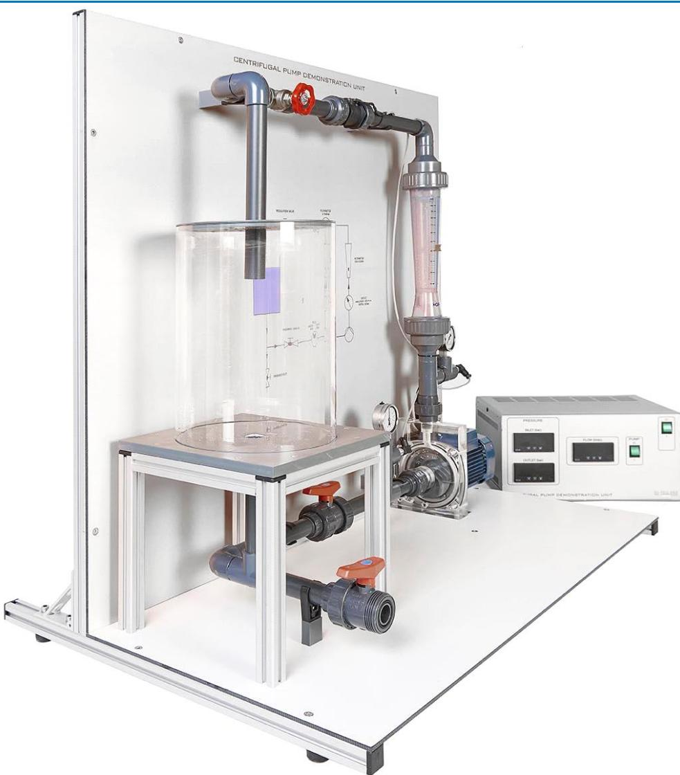
Con este equipo se pretende realizar una parte de las operaciones tanto de puesta en marcha como de funcionamiento de una instalación de bombeo. Estudio de las características de una bomba funcionando de forma individual realizando las prácticas y experiencias que se enumeran a continuación:
