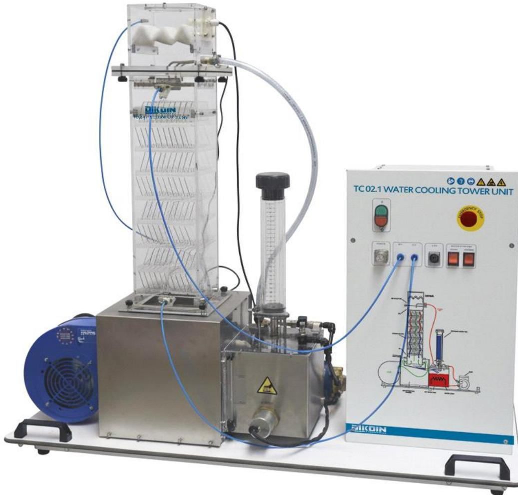
El equipo TC 02.1, muestra un método de enfriamiento de agua habitual en la industria. Este método consiste en enfriar el agua caliente hasta la temperatura ambiente.
