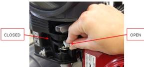
En cambio si el motor está caliente la posición adecuada será OPEN.
