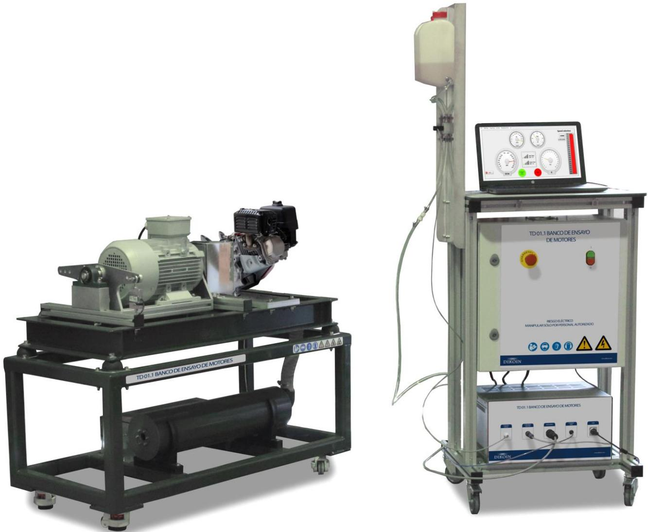
El equipo TD 01.1, ha sido diseñado para el estudio y comprensión del comportamiento de un motor de combustión de cuatro tiempos de gasolina.
