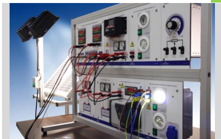
EN 01.4 - DEMOSTRADOR DE ENERGÍA FOTOVOLTAICA AISLADA (pag. E - 1)
