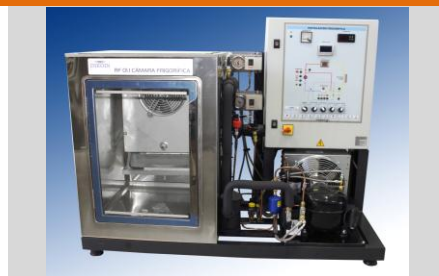
RF 01.1 - COOLING CHAMBER (pag. F - 1)
