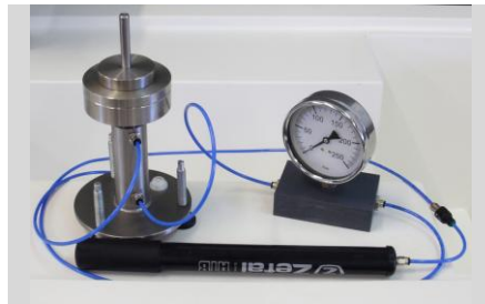
FLB 13.1 - DEAD WEIGHT CALIBRATOR (pag. A - 14)
