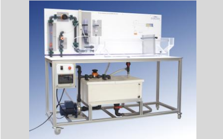
TA 02.2 - SEDIMENTATION TANK (pag. I - 2)
