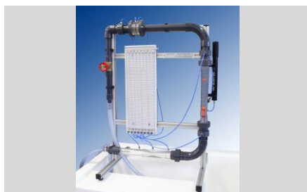
FLB 23.1 - DEMOSTRACIÓN DE CAUDALÍMETROS (pag. A - 15)
