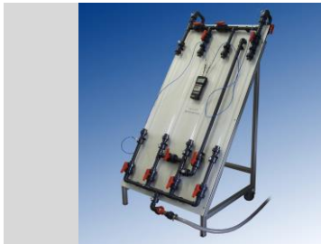
FL 27.2 - REDES DE FLUJO Y FRICCIÓN EN TUBERÍAS (pag. A - 11)
