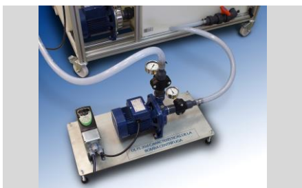
FLB 03.2 - MÓDULO - CARACTERÍSTICAS DE LA BOMBA CENTRÍFUGA (pag. A - 13)
