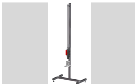
FL 14.3 - VISCOSIDAD POR CAÍDA DE BOLA (pag. A - 7)
