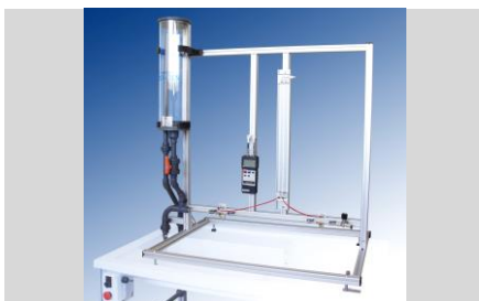
FL 17.1 - FRICCIÓN EN TUBERÍAS (pag. A - 9)
