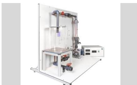
MH 01.1 - UNIDAD DE DEMOSTRACIÓN DE BOMBA CENTRÍFUGA (pag. B - 2)
