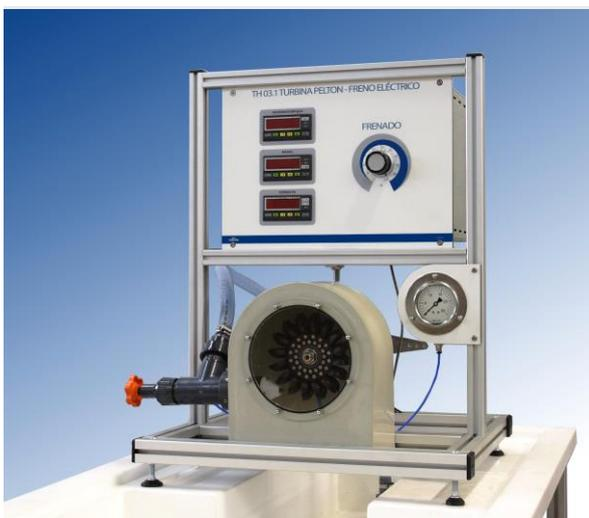
El equipo TH 03.1 simula una instalación a pequeña escala con una turbina Pelton.
