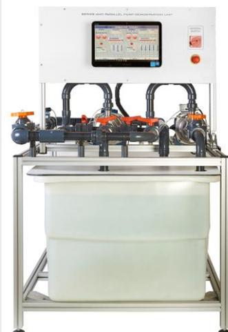
Con este equipo se pueden practicar gran parte de las operaciones, tanto de puesta en marcha, como de funcionamiento y regulación necesarias en una instalación de bombeo.
