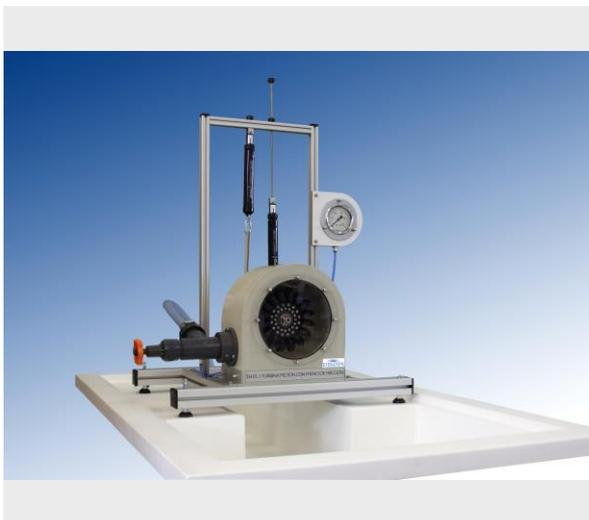
El equipo TH 01.1 simula una instalación a pequeña escala con una turbina Pelton. Se ha diseñado con especial hincapié el aspecto didáctico del mismo, pudiéndose observar en todo momento el funcionamiento del sistema y los diferentes componentes que lo constituyen.
