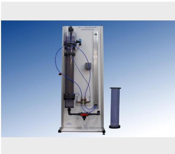
Con el equipo HD 11.1, se trata de conocer la facilidad que posee un terreno, al paso del agua por su interior, mediante la obtención de su coeficiente de permeabilidad  $k$ , aplicando la Ley de Darcy.
