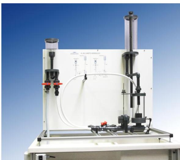
El equipo FL09.2 se trata de un equipo con el que se pretende demostrar y estudiar el fenómeno conocido como *golpe de ariete*, dicho fenómeno es el que se produce debido al cierre rápido del paso del agua a través de una tubería. El diseño del equipo se realiza con especial hincapié en el ámbito didáctico, por ello se suministra con elementos variables, para conseguir realizar una mayor cantidad de ensayos para una mejor comprensión por parte del alumno.
