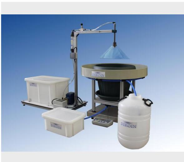
Con el equipo HD 10.1, se trata de conocer la capacidad de retención de agua de un suelo mediante el empleo del balance hidrológico, diferenciando cada uno de sus elementos.
