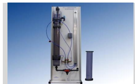
HD 11.1 - DEMOSTRADOR DE INFILTRACIÓN (pag. C - 4)
