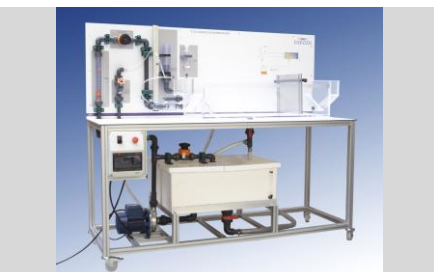
TA 02.2 - SEDIMENTATION TANK (pag. C - 5)
