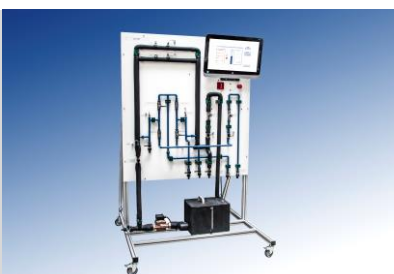
TC 07.1 - TRANSFERENCIA DE CALOR EN TUBOS CONCÉNTRICOS (pag. F - 2)
