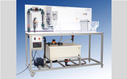
TA 02.2 - TANQUE DE SEDIMENTACIÓN (pag. 1 - 2)
