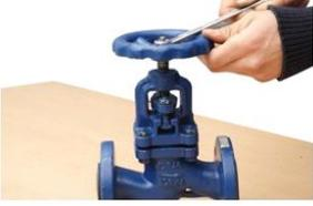
2. A continuación soltar las tuercas que unen la tapa (2) y el cuerpo (11) de la válvula. Para esta operación son necesarias dos llaves fijas una de 13 mm y otra de 14 mm.
