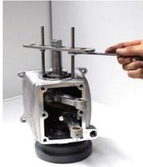
Después de haber levantado un espacio el cigüeñal chocara con la base. Para prevenir que se dañe el cigüeñal se aflojan las tuercas y se coloca un taco entre la tapa y la base para poder darle más altura. Y se continúa apretando las tuercas para acabar de soltar el cigüeñal.
