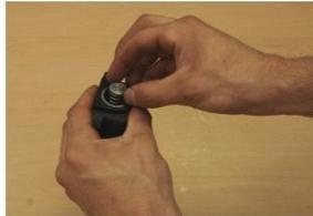
d. Por último enroscar la cabeza de la válvula teniendo en cuenta que lleva una arandela metálica. Apretar con una llave inglesa o una llave fija de 30 mm.
