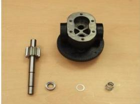
a. En primer lugar colocar el eje conductor.
