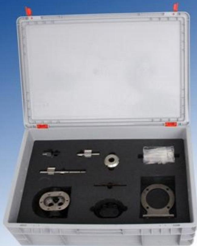
El kit de montaje y mantenimiento MM07 permite realizar el montaje y el mantenimiento de una bomba de engranajes. En este tipo de bombas el caudal es proporcional a la velocidad de giro de los engranajes (rpm) y con ellas se alcanzan presiones y caudales de servicio altos. Son empleadas habitualmente con fluidos de alta viscosidad y libres de partículas sólidas. Gracias al despiece el alumno aprende todos los componentes de la bomba y su funcionamiento.
