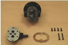
3. A continuación proceder a desmontar una de las dos partes. En este caso paso se procede a desmontar el cuerpo.
