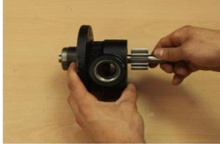
4. Finalmente proceder a desmontar la tapa. Para ello hacer uso de una llave inglesa o llave fija de 30 mm que permita soltar la válvula bypass. A partir de aquí las piezas de la válvula se pueden ir retirando sin ayuda de ninguna otra herramienta adicional.
