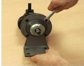
Como resultado se obtiene la bomba de tornillo, el soporte y los elementos de unión.
