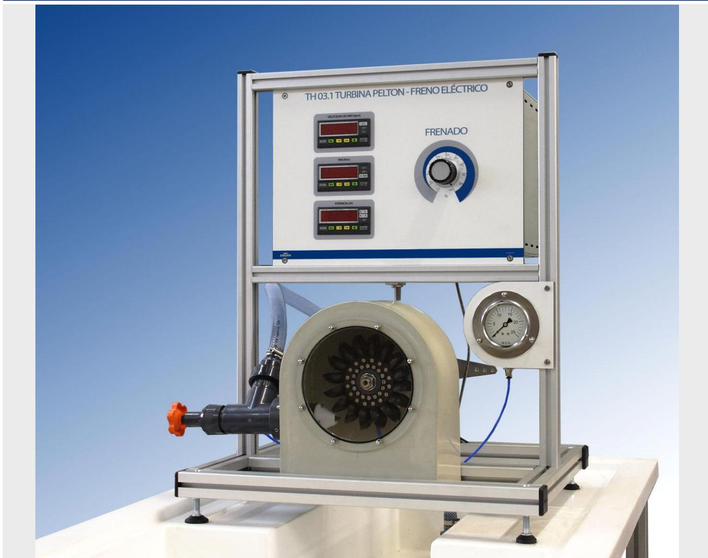
El equipo TH 03.1 simula una instalación a pequeña escala con una turbina Pelton.
