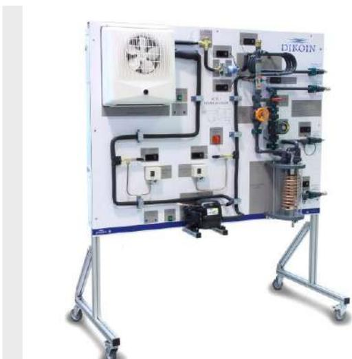
El equipo AC 03.1 demuestra de forma clara el funcionamiento de una bomba de calor aire/agua.
