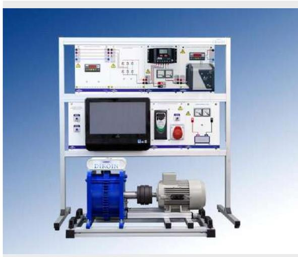
Con el equipo EN 04.4, emulamos el comportamiento de un aerogenerador de una manera práctica y didáctica. Un motor eléctrico hace las veces de las palas y el buje de un aerogenerador arrastrando a un generador síncrono trifásico de imanes permanentes, el cual transforma la energía mecánica transmitida al eje en energía eléctrica a la salida.
