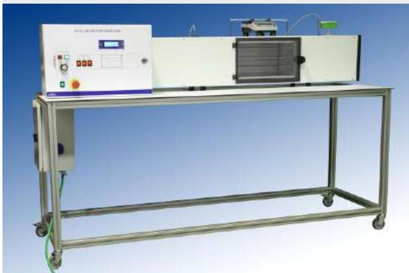
El objetivo del equipo IQ 01.5 es analizar el secado por convección del elemento a estudiar, modificando el ambiente en el que se encuentra y reflejar los datos de los cambios producidos.
