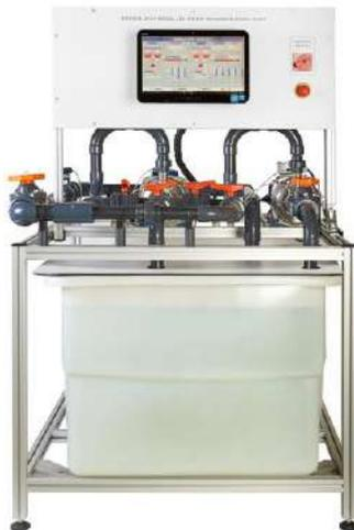
Con este equipo se pueden practicar gran parte de las operaciones, tanto de puesta en marcha, como de funcionamiento y regulación necesarias en una instalación de bombeo.
