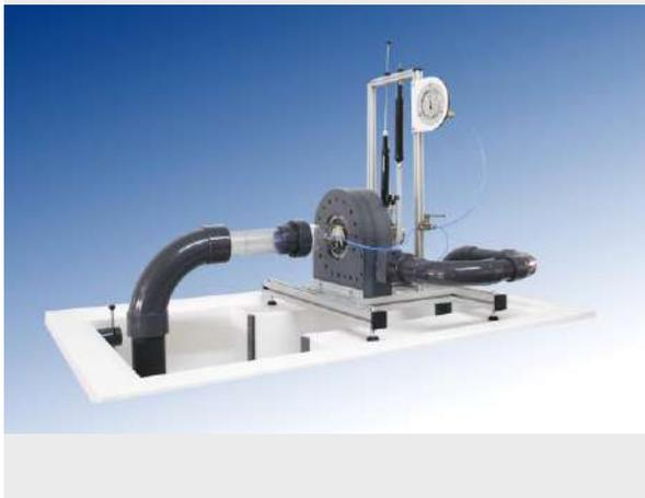
El equipo TH 01.4 simula una instalación a pequeña escala con una turbina Kaplan/Hélice, y está diseñado para el estudio y visualización tanto del comportamiento como de sus características.
