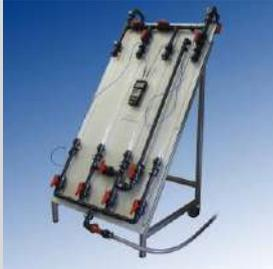
FL 27.2 - REDES DE FLUJO Y FRICCIÓN EN TUBERÍAS (pag. A - 11)
