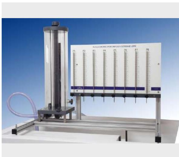
Este equipo, que trabaja sobre el banco hidráulico (FL 01.4, FL 01.5 ó FL 01.6), ha sido diseñado para el estudio de todo lo concerniente a la salida de caudal por orificios, dispuestos de forma que el chorro salga en dirección horizontal.
