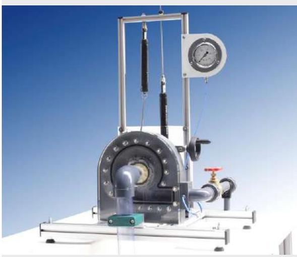
El equipo TH 01.2 simula una instalación a pequeña escala con una turbina Francis. Se ha diseñado con especial hincapié el aspecto didáctico del mismo, pudiéndose observar en todo momento el funcionamiento del sistema y los diferentes componentes que lo constituyen.
