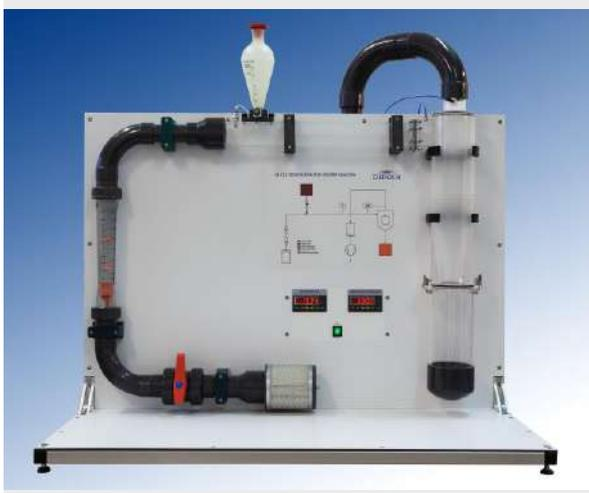
Los ciclones son equipos muy utilizados en la industria que permiten la separación mediante la fuerza centrífuga de partículas sólidas que se encuentran suspendidas en un gas. Son equipos sencillos cuyo funcionamiento se basa en la separación de las partículas mediante la fuerza centrífuga, y que al no poseer partes móviles tienen un mantenimiento muy sencillo. Como inconveniente podemos destacar que son poco flexibles a los cambios de concentración, caudal o tamaño de las partículas.
