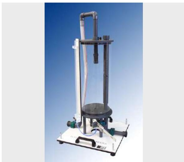
El equipo FL12.1 ha sido diseñado para el estudio de todo lo que concierne al fenómeno de contracción que se produce cuando un chorro de fluido atraviesa un orificio. Ha sido diseñado con especial hincapié en su utilización didáctica y es por ello que el equipo cuenta con tres boquillas cuya geometría difieren entre ellas, pudiendo realizarse ensayos en distintas condiciones, facilitando al alumno la comprensión del fenómeno que se produce.
