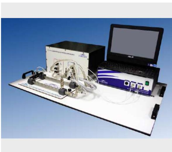
El equipo TC 01.1, es el elemento central del conjunto de intercambio de calor TC 01. Es el módulo que proporciona agua caliente y fría a los intercambiadores de calor, además de medir las temperaturas y caudales en cada elemento.
