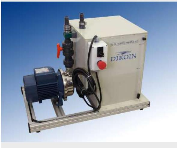
Este grupo hidráulico ha sido diseñado con el objetivo de constituir una unidad autónoma, portátil y económica, de suministro de energía hidráulica.
