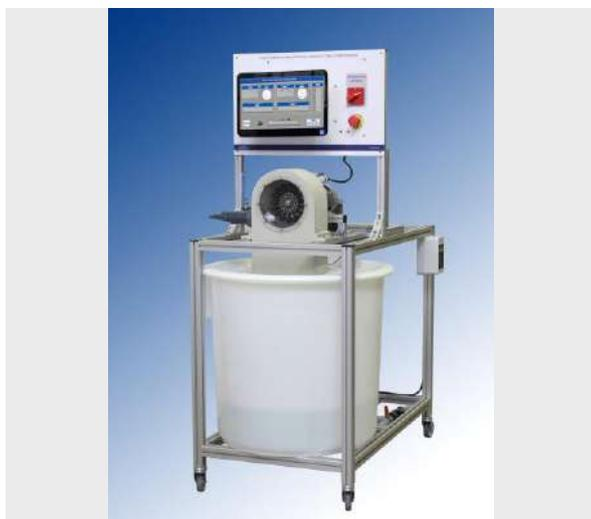
El equipo TH 04.1 simula una instalación a pequeña escala con una turbina Pelton, y está diseñado para el estudio y visualización tanto del comportamiento como de sus características.
