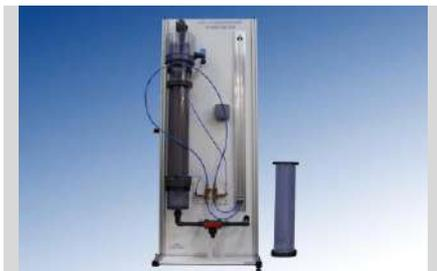
HD 11.1 - DEMOSTRADOR DE INFILTRACIÓN (pag. C - 5)
