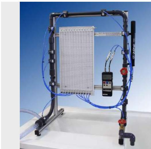
Para calcular las **pérdidas de carga secundarias producidas por los accesorios de una instalación**, tomamos datos de la diferencia de presiones entre las tomas manométricas aguas arriba y abajo del elemento a medir, además, debemos restar las pérdidas de carga primarias existentes debido a los tramos rectos de tubería.
