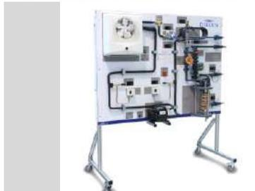
AC 03.1 - DEMOSTRACIÓN DE BOMBA DE CALOR (pag. F - 1)
