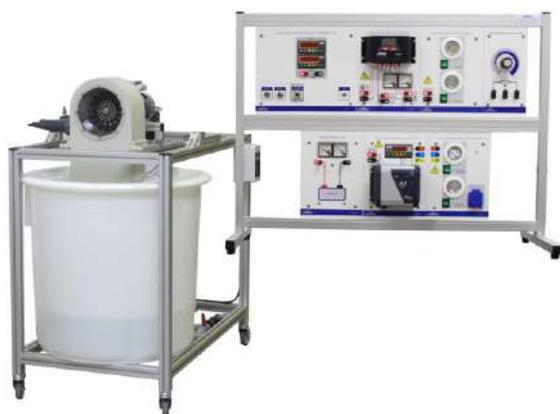
El equipo EN 05.1 está diseñado como una pequeña instalación de energía hidráulica con una turbina Pelton totalmente funcional, y todos los elementos necesarios para completar la instalación.
