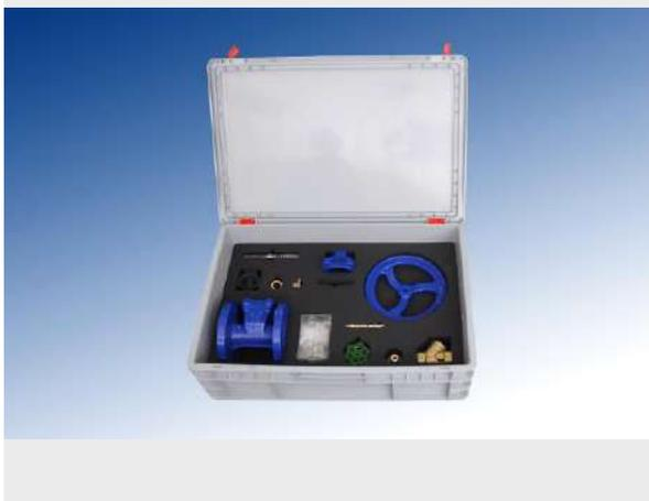
El kit de montaje MM11 permite analizar las diferencias una compuerta plana de cuña y una válvula de asiento inclinado. Gracias al despiece de cada sistema es posible estudiar cada uno de los distintos componentes y su funcionamiento.
