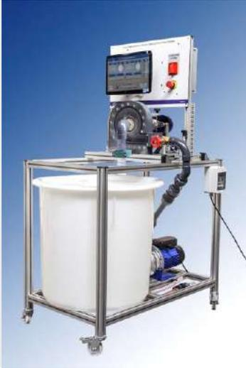
El equipo TH 04.2 simula una instalación a pequeña escala con una turbina de Francis o de reacción. Está diseñado para el estudio y visualización tanto del comportamiento como de las características de una turbina Francis.
