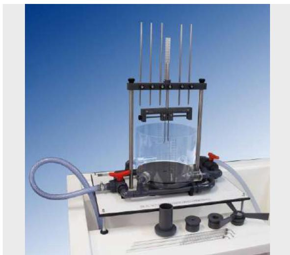
El objetivo de este equipo es la visualización y estudio de la formación de los vórtices libres y forzados. Se denomina **Vórtice Forzado** a la rotación de un fluido que se mueve como un sólido respecto a un eje. Por definición, en el vórtice forzado cada partícula de fluido tiene la misma velocidad angular.
