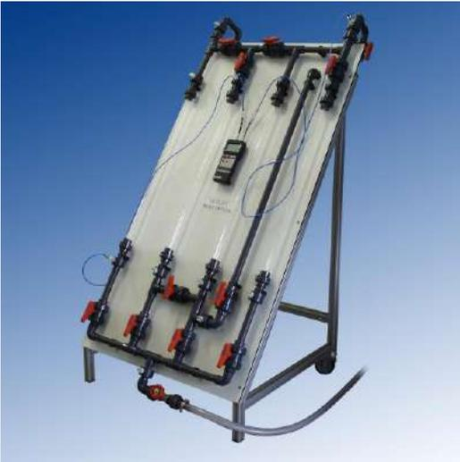
El equipo "Redes de flujo" refleja a escala el problema que habitualmente aparece para el cálculo de presiones y caudales en tuberías que se interconectan entre sí. Estas tuberías habitualmente son de diferentes diámetros y longitudes y forman entre sí diversos sistemas (en serie, en paralelo, red mallada...) lo que complica severamente el cálculo.
