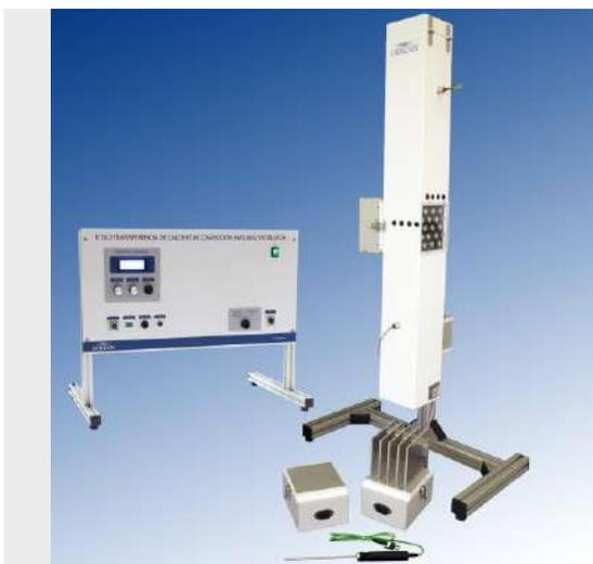
El equipo IT 03.2, es un equipo de sobremesa muy útil para el estudio de la transferencia de calor por convección natural o forzada.
