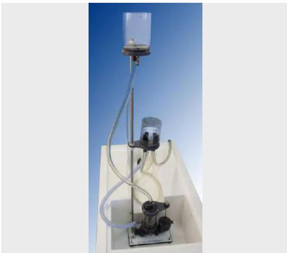
Con este equipo se pretende estudiar y demostrar el funcionamiento de un ariete hidráulico, sistema por el cual conseguimos elevar un líquido a una altura superior a la altura de suministro, sin aporte de energía exterior.
