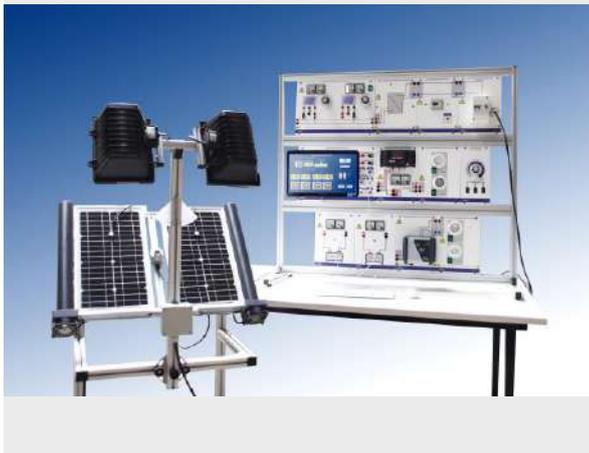
El equipo EN 01.6 reproduce a escala una instalación solar fotovoltaica completa. Se ha diseñado con especial hincapié el aspecto didáctico del mismo, pudiéndose observar a primera vista todos los componentes que tiene una instalación solar fotovoltaica y su disposición. Permite el estudio, tanto de instalaciones de energía solar fotovoltaica aisladas, como de conexión a red.
