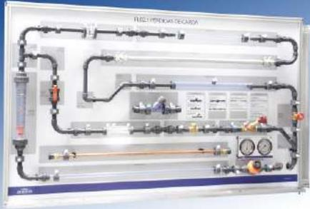
El equipo FL02.1 ha sido diseñado para el estudio, tanto de las pérdidas por fricción en tuberías, como de las pérdidas producidas por elementos característicos de las instalaciones como son; accesorios, válvulas y elementos de medida.
