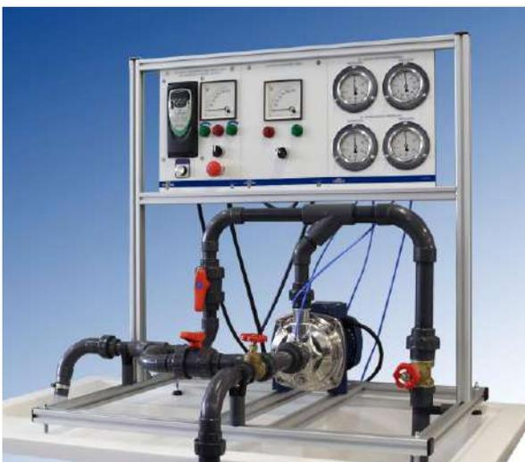
El equipo está diseñado para funcionar sobre el banco hidráulico. La instalación va montada sobre un marco construido con perfiles de aluminio, contando con un sistema de tuberías y válvulas que permite que se puedan acoplar la bomba del banco hidráulico y la del equipo tanto en serie como en paralelo.
