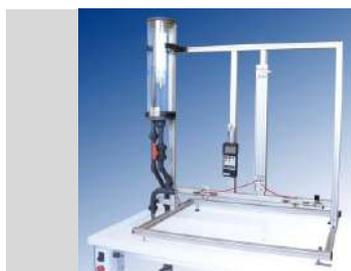
FL 17.1 - FRICCIÓN EN TUBERÍAS (pag. A - 9)
