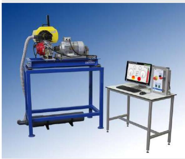
El equipo TD 01.1, ha sido diseñado para el estudio y comprensión del comportamiento de un motor de combustión de cuatro tiempos de gasolina. Con este equipo se pueden realizar los ensayos necesarios para la obtención de los datos característicos del funcionamiento del motor, familiarizándose así los estudiantes, con las curvas presentadas por los fabricantes de los mismos como muestra de su funcionamiento.
