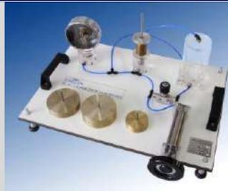
FL 13.1 - CALIBRACIÓN DE MANÓMETROS (pag. A - 6)
