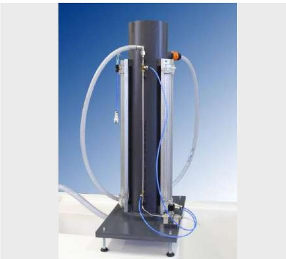
El objetivo que se pretenden alcanzar con este equipo es el estudio de las pérdidas de carga primarias que se producen a lo largo de una tubería, en dos regímenes: **laminar y turbulento**.
