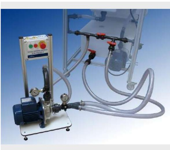
Las bombas se incluyen en un sistema de tuberías para convertir energía mecánica en energía hidráulica. Esta energía adicional permite transmitir un fluido de un lugar a otro cuando no es factible que fluya por gravedad, elevarlo a cierta altura sobre la bomba o recircularlo en un sistema cerrado. En general, el efecto de una bomba en un sistema es **incrementar la energía total en una cantidad H**.
