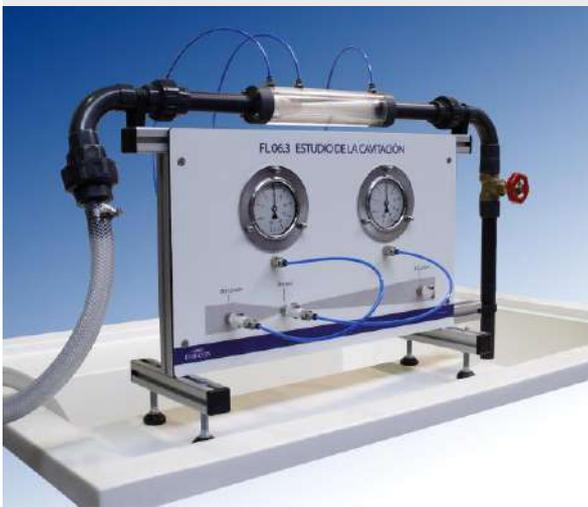
El equipo de demostración del fenómeno de la CAVITACIÓN, es un equipo sencillo que va acoplado a un banco hidráulico o cualquier otra fuente de suministro de energía hidráulica.
