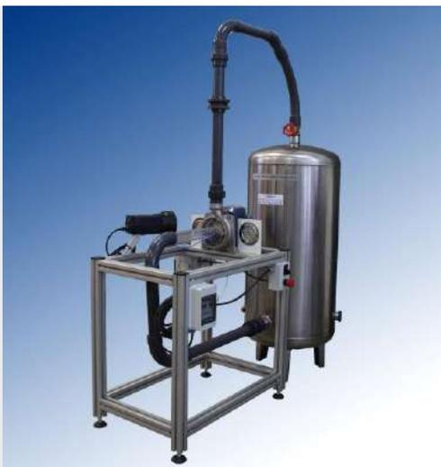
El fenómeno de la cavitación se produce cuando la presión del líquido que estamos bombeando disminuye hasta la de su presión de vapor para la temperatura de funcionamiento. En ese momento el líquido se vaporiza, formándose cavidades o bolsas de vapor que son arrastradas hacia zonas con una presión superior donde se vuelven a condensar generando sobrepresiones puntuales muy elevadas.
