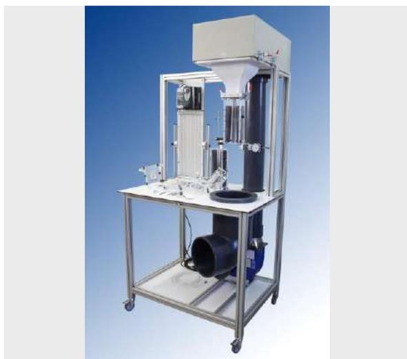
El banco de aerodinámica está diseñado para la realización de una gran variedad de experiencias en el campo de la mecánica de fluidos, utilizando para ello una corriente controlada de aire.
