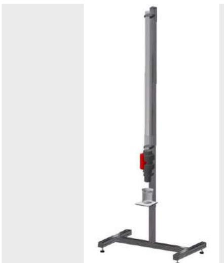
El equipo FL 14.3, está pensado para determinar de una forma rápida y sencilla, la viscosidad dinámica de un fluido.
