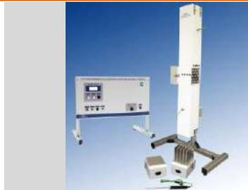
IT 03.2 - TRANSMISIÓN DE CALOR POR CONVECCIÓN NATURAL Y FORZADA (pag. F - 1)
