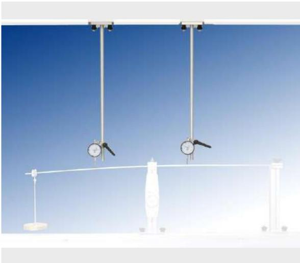
Sistema de medición de desplazamiento para uso con equipos de la gama ST, en bastidor para estructuras planas.
