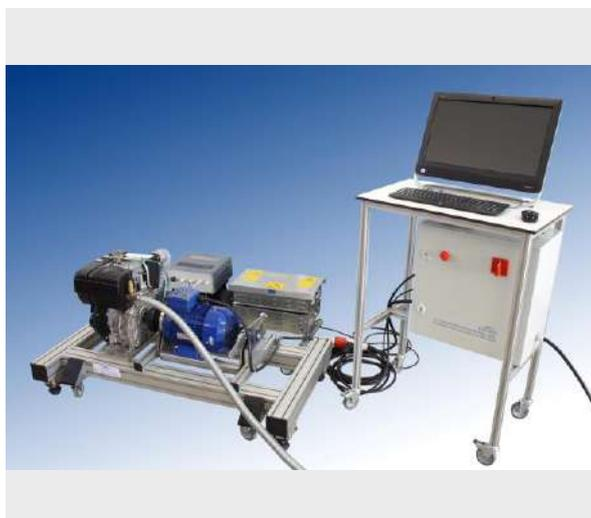
Equipo diseñado para el estudio y comprensión del comportamiento de un motor de combustión diesel monocilíndrico de cuatro tiempos.
