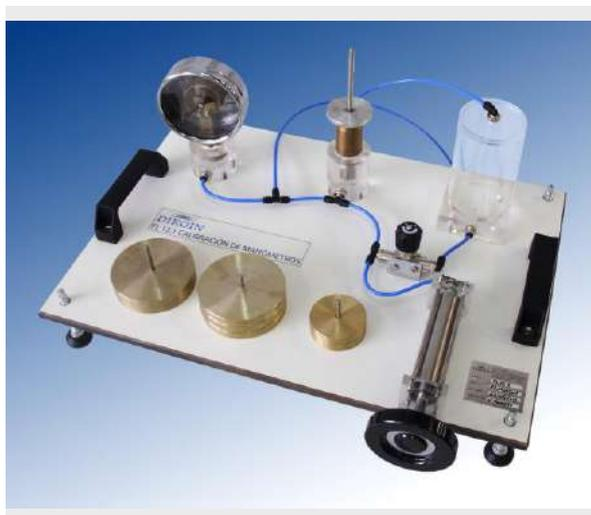
El objetivo que se pretende alcanzar con este equipo es el estudio y calibración de manómetros, así como la visualización y comprensión de su funcionamiento.
