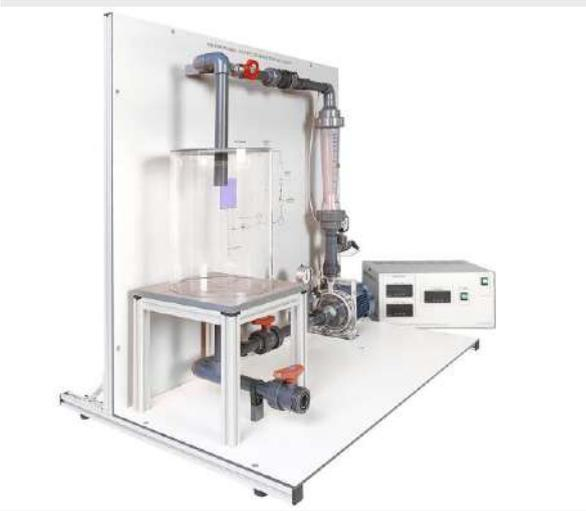
Con este equipo se pretende realizar una parte de las operaciones tanto de puesta en marcha como de funcionamiento de una instalación de bombeo. Estudio de las características de una bomba funcionando de forma individual realizando las prácticas y experiencias que se enumeran a continuación:
