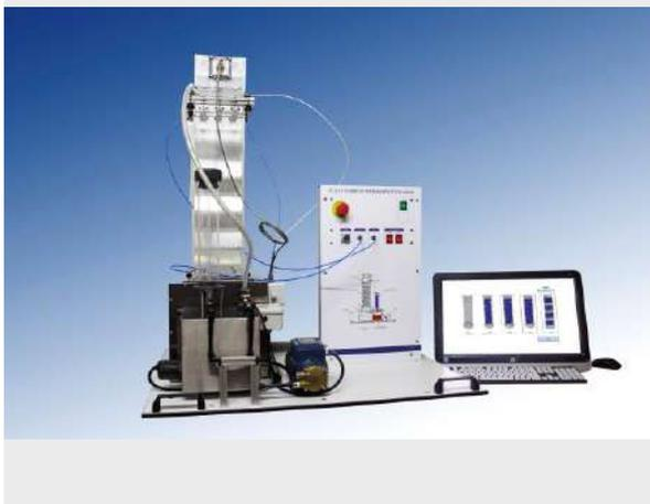
El equipo TC 02.1, muestra un método de enfriamiento de agua habitual en la industria. Este método consiste en enfriar el agua caliente hasta la temperatura ambiente.
