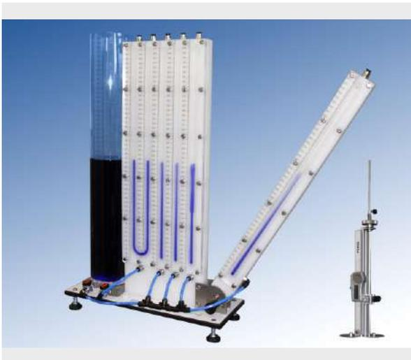
Equipo diseñado para el estudio de la estática de fluidos y de la medida de presiones con diferentes tipos de tubos piezométricos y elementos medidores de nivel tales como escalas graduadas y limnómetro.
