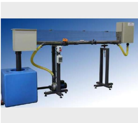
Este equipo está diseñado para estudiar el comportamiento de los fluidos en canales abiertos, mediante la realización de una amplia gama de prácticas y experiencias.
