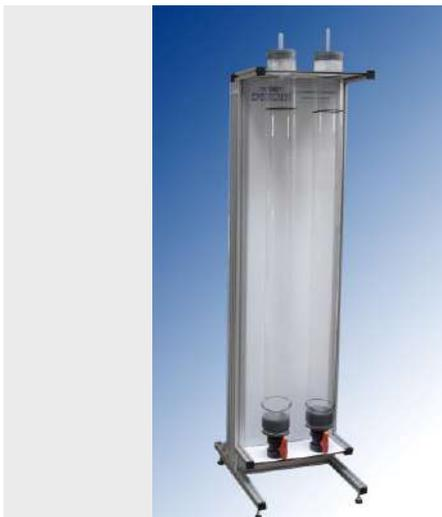
Este equipo ha sido diseñado para la determinación de la viscosidad de varios líquidos, y el estudio y comprobación de los coeficientes de resistencia de diversos cuerpos, con dimensiones, peso y forma geométrica diferentes.
