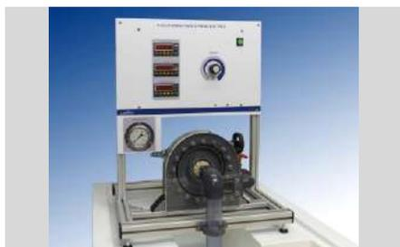
TH 03.4 - TURBINA KAPLAN/HÉLICE - FRENO ELÉCTRICO (pag. B - 5)
