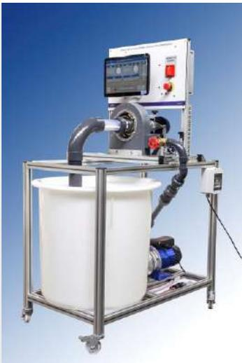
El equipo TH 04.4 simula una instalación a pequeña escala con una turbina Kaplan/Hélice, y está diseñado para el estudio y visualización tanto del comportamiento como de sus características.
