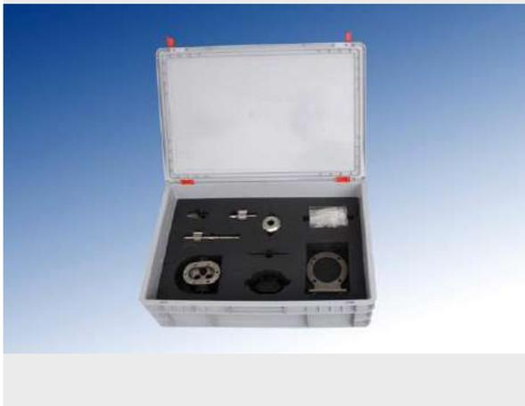
El kit de montaje y mantenimiento MM07 permite realizar el montaje y el mantenimiento de una bomba de engranajes. En este tipo de bombas el caudal es proporcional a la velocidad de giro de los engranajes (rpm) y con ellas se alcanzan presiones y caudales de servicio altos. Son empleadas habitualmente con fluidos de alta viscosidad y libres de partículas sólidas. Gracias al despiece el alumno aprende todos los componentes de la bomba y su funcionamiento.
