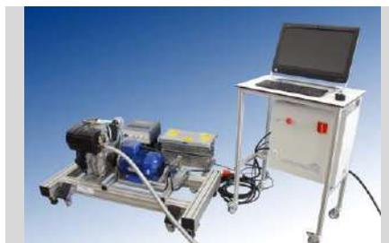
TD 01.2 - BANCO DE ENSAYO DE MOTORES DIESEL (pag. F - 3)
