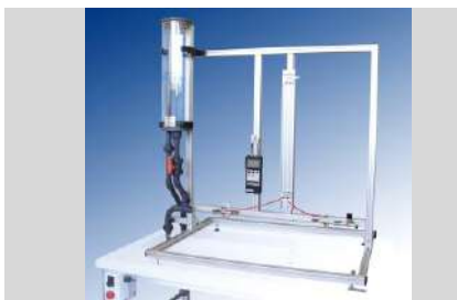
FL 17.1 - FRICCIÓN EN TUBERÍAS (pag. A - 9)
