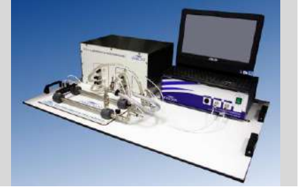
TC 01.1 - ALIMENTADOR PARA INTERCAMBIADORES DE CALOR (pag. F - 1)
