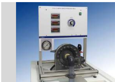
TH 03.2 - TURBINA FRANCIS - FRENO ELÉCTRICO (pag. B - 4)
