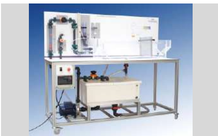
TA 02.2 - TANQUE DE SEDIMENTACIÓN (pag. C - 5)
